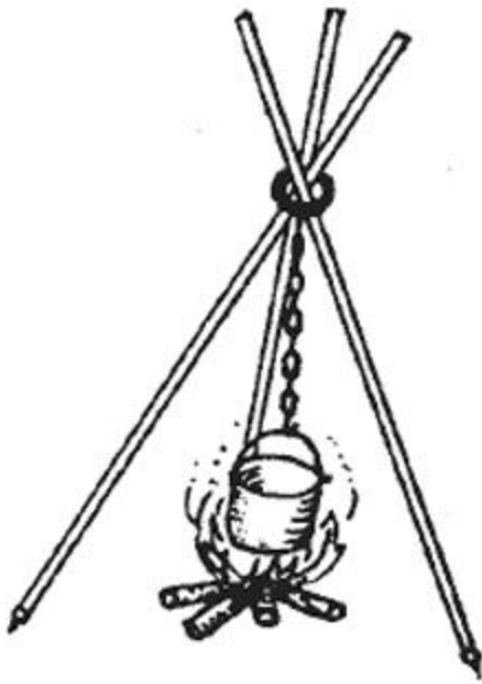
Рис. 4. Подвеска для котелка на треноге из альпеншоков.
