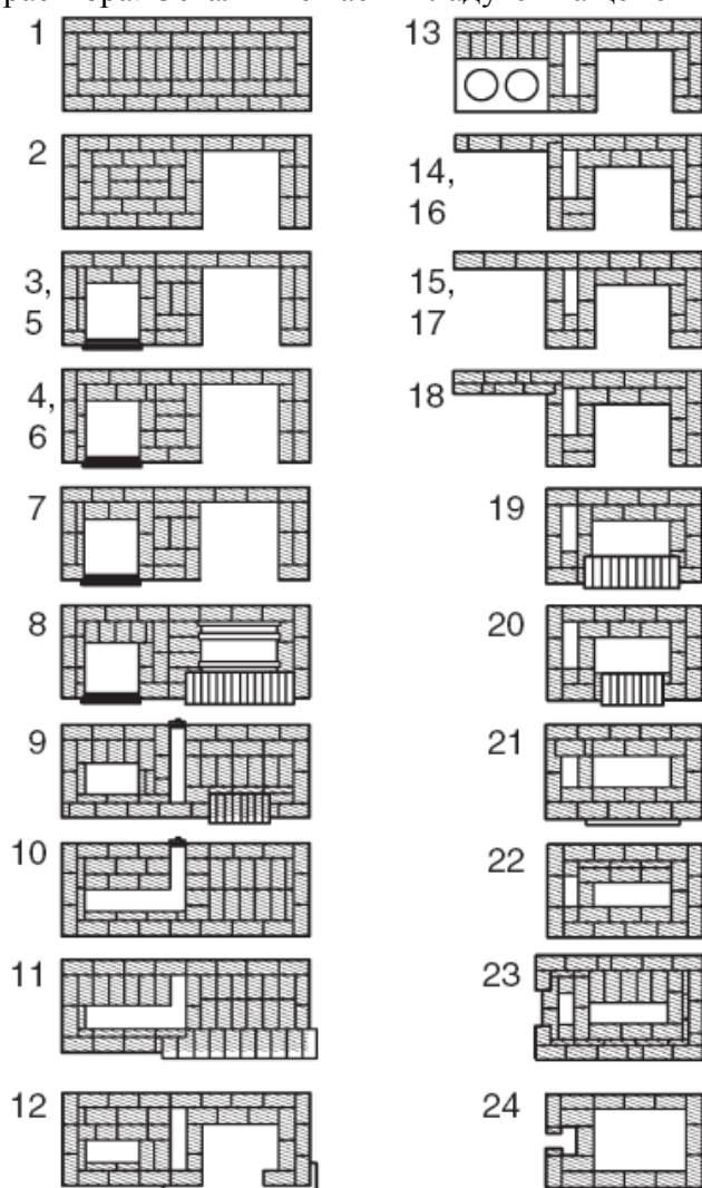
Рис. 52. Порядовки садового камина с плитой
