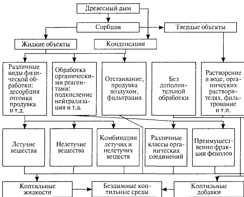
Рис. 19. Схема получения бездымных коптильных сред на основе сорбции древесного дыма
