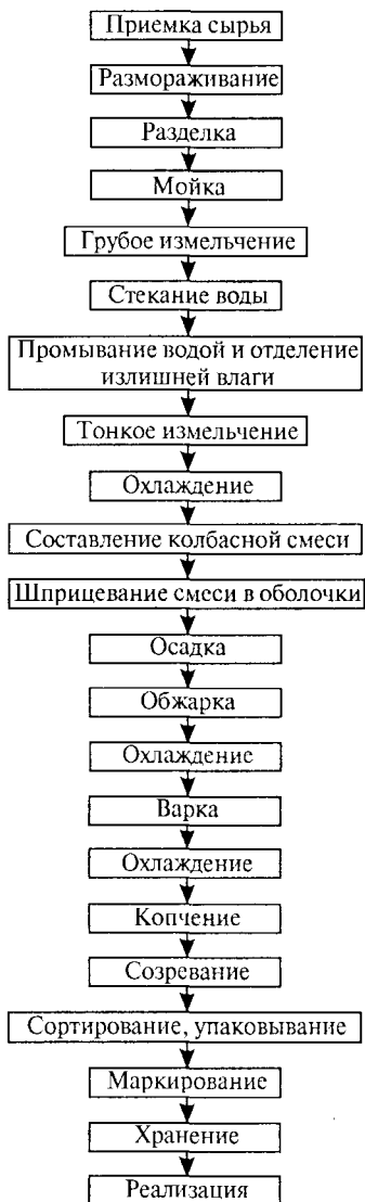
Рис. 12. Технологическая схема производства колбасы рыбной полукопченой
