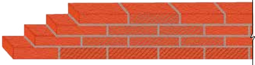
▲ Рис. 15. Перевязка вертикальных швов на полкирпича
