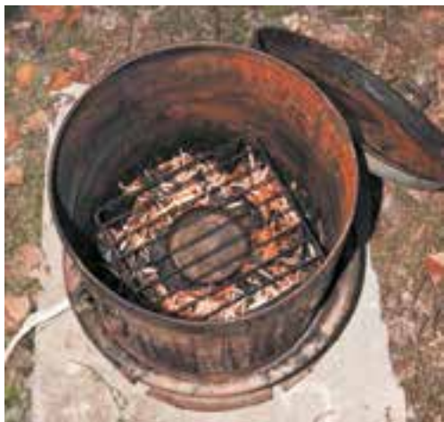
▲ Коптильная камера со стружками на дне и опорой для поддона установлена на нагреватель
